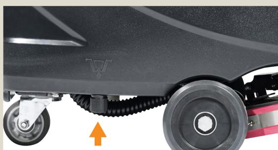
**Tous les jours :** Vider le réservoir d'eau propre en ouvrant le bouchon de vidange situé sous la machine.
