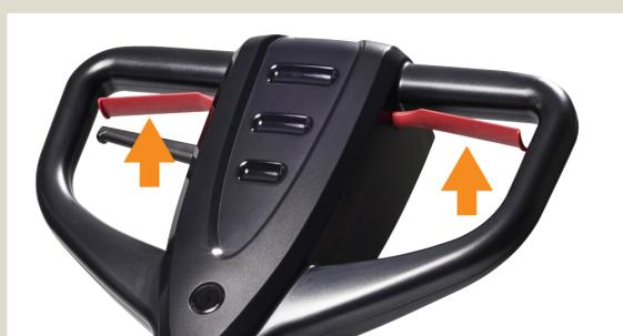
Commencer le nettoyage en mettant les mains sur les interrupteurs de sécurité.
