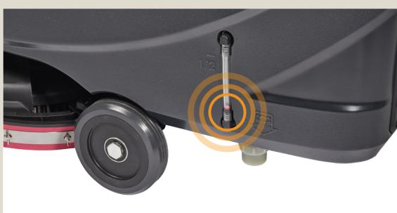
Vérifier le niveau de solution à l'aide de la bille rouge à gauche de la machine.
