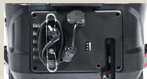
**Tous les jours :** Charger les batteries : Brancher le câble de charge de la batterie sur la machine et sur la prise murale. Le témoin s'allume en rouge pendant le chargement et en vert à l'issue du chargement.
