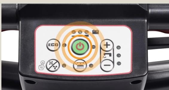
À l'issue du nettoyage, appuyer sur le bouton marche/arrêt pour éteindre la machine et effectuer la maintenance ci-dessous.
