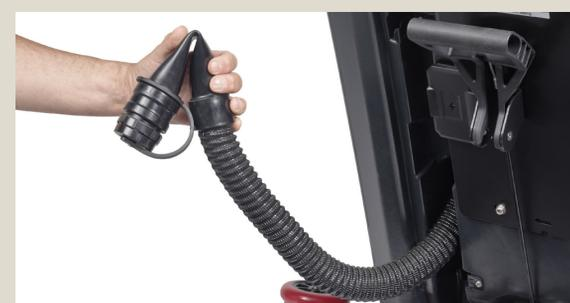
**Tous les jours :** Vider le réservoir de récupération à l'aide du tuyau de vidange. Recourber la partie souple avant de retirer le capuchon pour contrôler le débit.
