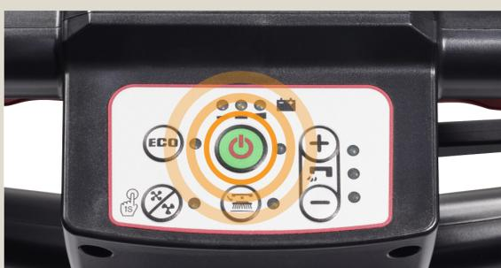
Démarrer la machine et vérifier qu'il y a assez de batterie pour réaliser le nettoyage. Recharger la batterie si nécessaire.
