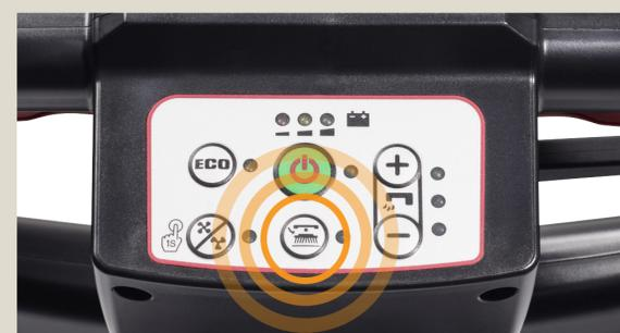
**Tous les jours :** Avec la machine allumée et le plateau remonté, appuyer sur le bouton de désenclenchement pour retirer la brosse/le disque puis le nettoyer ou le vérifier avant utilisation.
